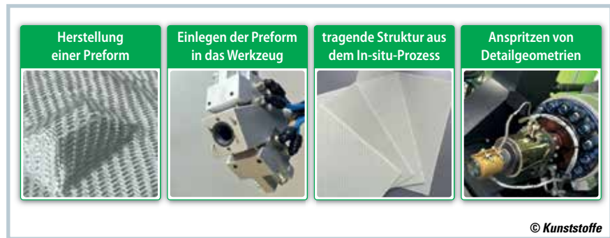
Bild 1. Schematischer Prozessablauf bei der Herstellung von In-situ-Bauteilen mit angespritzten Detailgeometrien: Die Prozessintegration steigert die Wirtschaftlichkeit des Fertigungsverfahrens (Quelle: Engel)
