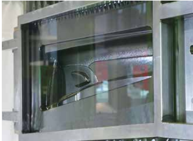
Bild 4. Während des Aufheizens beginnt der Prägeprozess, indem die Folie (hier schwarz) durch Vakuum in die IMG-Form gezogen wird (© Engel)
