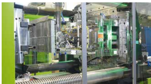
Bild 3. Die Infrarot-Strahler zum Aufheizen der Folie sind in den Greifer des Linearroboters integriert (© Engel)
