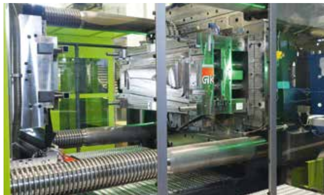
Bild 2. Blick ins Werkzeug: Durch das sogenannte In-Mold Graining erhält die Folie die gewünschte Oberflächenstruktur (© Engel)
